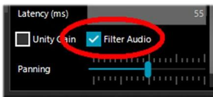
Basta con marcar 'Filter Audio' en la sección Audio de SDR# para tener un audio perfectamente simétrico en nuestras grabaciones.
