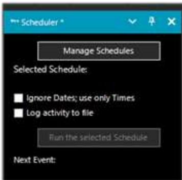
Proporciona un medio para crear, utilizar y reutilizar programaciones (u horarios) y gestionar sus frecuencias. Se pueden definir múltiples horarios operativos, cuando se activa un horario, el Programador activará la frecuencia en las fechas y horas especificadas.
