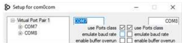
"com0com". Los números reales que se asignarán a los puertos COM dependen de la configuración de tu sistema (en mi caso COM7 y COM8). Por lo tanto, seleccioné el COM7 en el SDR# y el COM8 en el otro software con el que quería interactuar. Como el CAT es un protocolo bidireccional, los cambios realizados en el SDR# se enviarán inmediatamente al otro software y viceversa...
