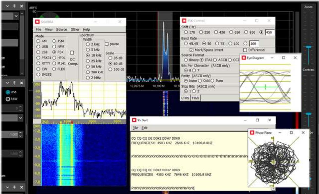
Aquí vemos a SIGMIRA con muchas de sus ventanas abiertas (seleccionables desde el menú VIEW), trabajando con una señal RTTY (50 baudios inversos, desplazamiento 450 Hz) sintonizada a través del HF+ Discovery (en modo USB) y decodificando los mensajes en la ventana "Rx text".
