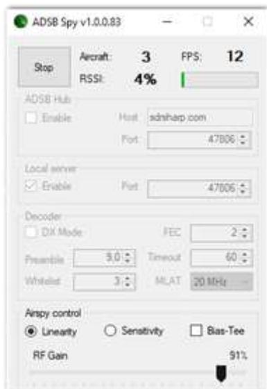
Una vez puesto en marcha, al cabo de unos instantes, verás aumentar los contadores de "Avión y FPS", que indican los paquetes de datos recibidos, proporcionando una visión en tiempo real de la correcta recepción, así como el indicador de intensidad de la señal recibida (RSSI). La dirección del puerto por defecto es 47806 y se utiliza para comunicarse con los programas de decodificación (ver más abajo).
