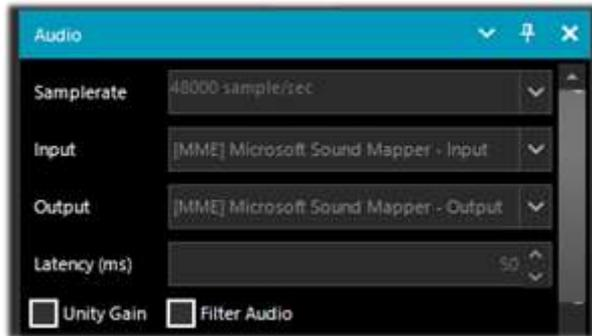
SDRsharp con entrada/salida para su tarjeta de sonido. También puedes utilizar la "Mezcla estéreo" activándola en la pestaña "Grabación" del panel de audio de Windows.
