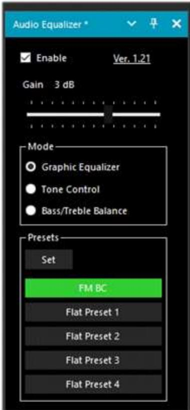
El plugin actualizado proporciona un ecualizador panorámico, control de tono y balance, compatible con el último SDR# Studio 32bit actualizado al nuevo .Net6.x (>= v.1888).
