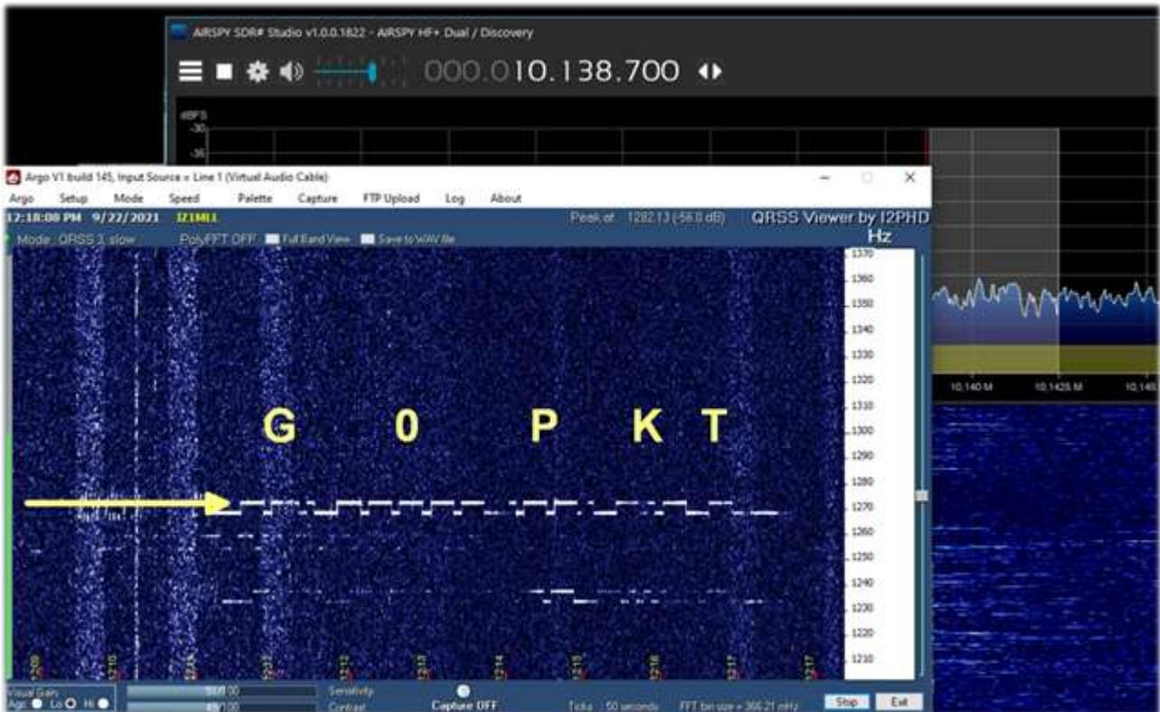
El receptor estaba sintonizado en 10138,7 kHz en USB y después de varios minutos recibí y decodifiqué la baliza inglesa GOPKT como se muestra en la primera línea.
