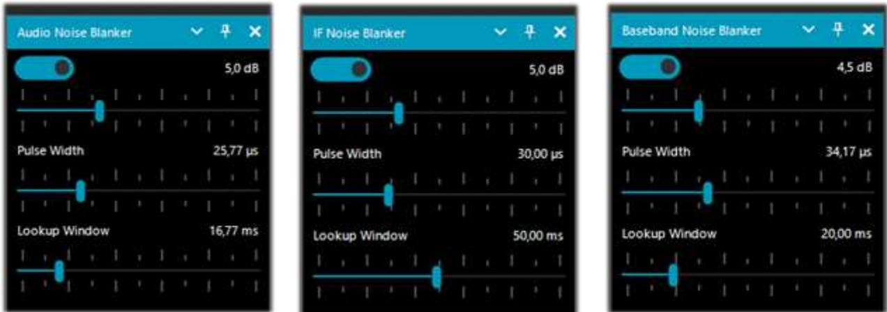
Evidentemente, no hay valores ni umbrales establecidos, por lo que *es necesario mover gradualmente los distintos deslizadores hasta que el ruido pulsante desaparezca o se reduzca sin distorsionar demasiado el audio recibido.*
