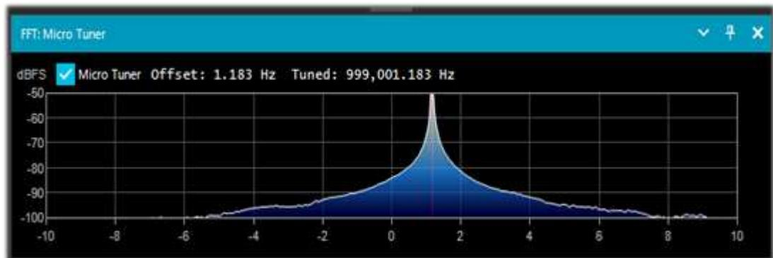
*Este panel se puede utilizar junto con el 'Cancelador de Co-canal AM' para conseguir un rechazo muy profundo de la emisora seleccionada gracias a un algoritmo totalmente nuevo con una implementación nativa*
