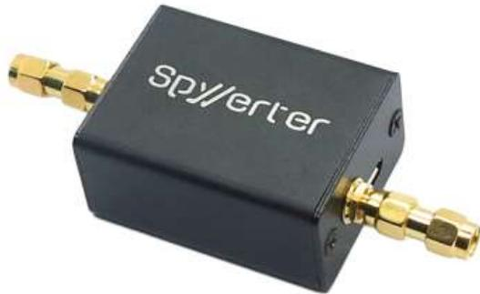
Se trata de un convertidor ascendente de bajas pérdidas y alto rango dinámico, del mismo tipo que se utiliza en los rx de HF de gama alta que, gracias a su estabilidad de frecuencia y sensibilidad, puede competir con los diseños analógicos a un coste muy asequible.
