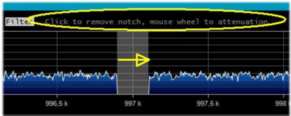
En cambio, al girar la rueda del ratón puedes cambiar la atenuación (de -160 dB a +100 dB).
