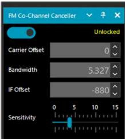
En este ejemplo vemos cómo configurar el panel para escuchar una emisora WFM con una señal muy fuerte en 91.500 MHz y una emisora más débil sintonizada en 91.600 MHz (línea roja vertical en el centro del BW a unos 100k).
