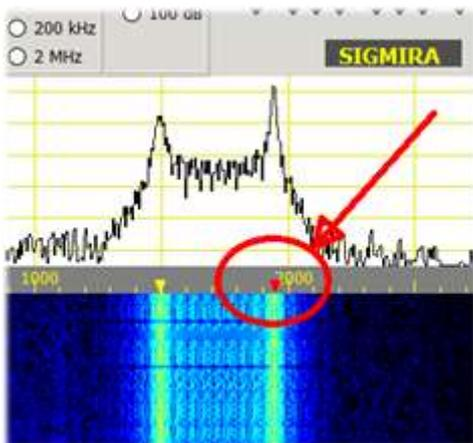
En el decodificador, he elegido el modo y los parámetros FSK, luego tienes que hacer clic en la cascada en la señal de la derecha marcada con el triángulo rojo.
