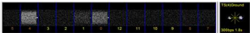
Cada estación terrestre tiene un desplazamiento de tiempo para sus Squitters, esto permite a las aeronaves cambiar entre estaciones terrestres cuando intentan conectarse a la mejor. Cuando se transmite el tráfico, se utiliza la multiplexación por división de tiempo (TDMA), que impide que dos aviones transmitan al mismo tiempo.
