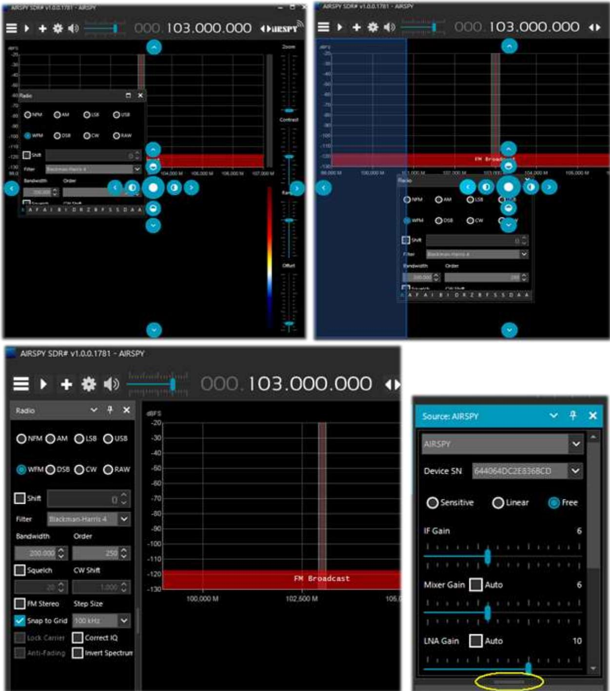
A partir de la versión 178x, los paneles disponen de una función de desplazamiento automático a la derecha, o para cambiar el tamaño, se puede utilizar la barra horizontal resaltada en amarillo con el ratón.
