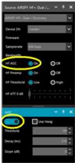
En AirSpy HF+, la ganancia de AGC está totalmente controlada por el software que se ejecuta en el DSP, que optimiza la distribución de ganancia en tiempo real para una sensibilidad y linealidad óptimas. ¡*Así que recuerda activarlos a ambos!*
