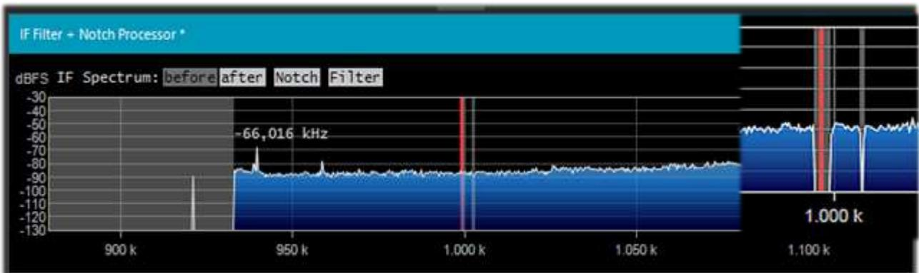
El **"Notch tracking"** permite configurar varias muescas, cada una con sus propias características de ancho de banda (Ancho en Hz) y atenuación (en dB).
