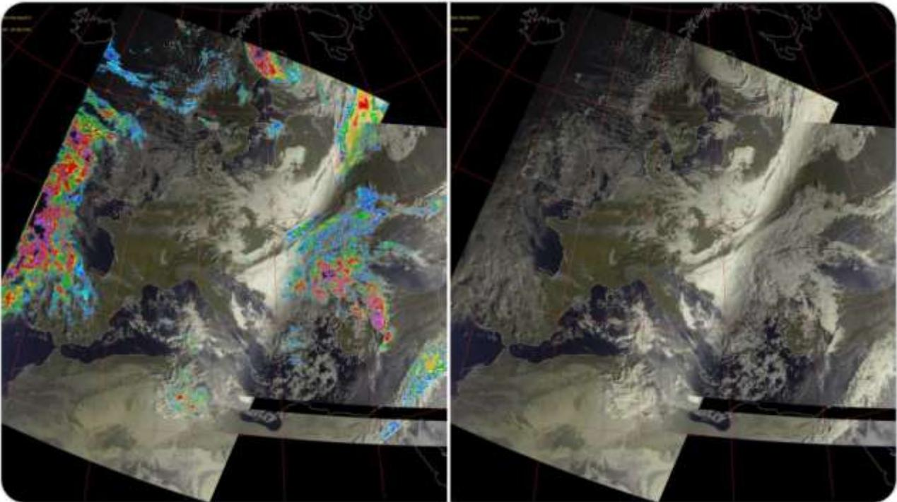
Imágenes LRPT recibidas a 137,1 MHz en modo RGB+Rainfalls/RGB con antena Turnstile y amplificador de bajo ruido SPF5189 RF. **Estos son los programas utilizados:** *Tracking DDE v1.2 + Demodulador Meteor v2.3 + Decodificador LRPT v2019.9.14.0056 + Postprocesador MeteorGIS v2.24.*
