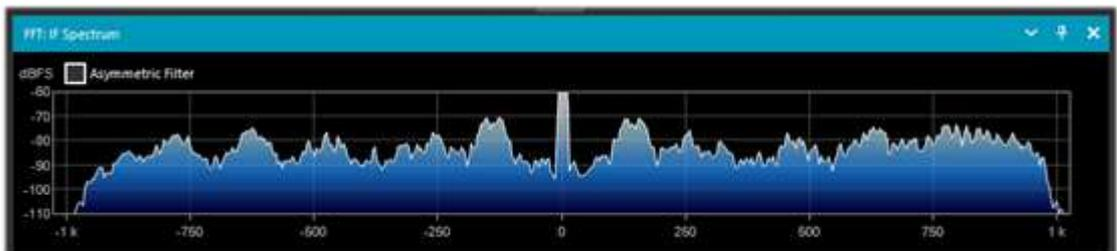
*Permite visualizar la estructura de la señal con una mejor resolución y, al activar el "Asymmetric filter", permite seleccionar en qué lado de la señal se va a trabajar.*
