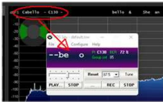
señales débiles de NFM y el RDS en el modo WFM. Con la v.1863/1865, se mejoró aún más la detección y decodificación de RDS incluso en señales pobres y difíciles. La pantalla de al lado muestra la diferencia con un decodificador externo de terceros (véase el capítulo "Salida MPX y RDS-Spy").
