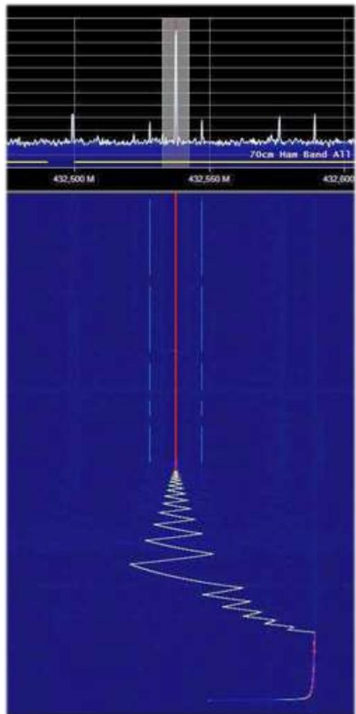
Comienza con una nota variable que baja y sube de frecuencia en pocos segundos, hasta que se asienta en lo que podría sonar como una nota de encendido/apagado (con portadora central AM y morse) clásico NDB todavía presente en onda larga
