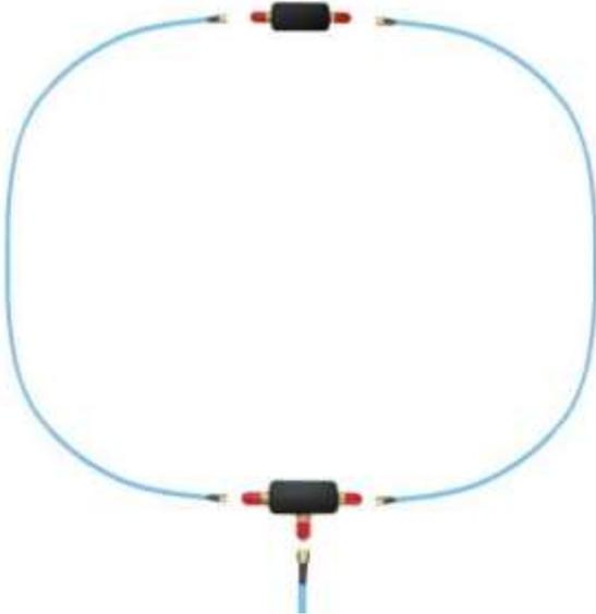
es muy grande en comparación con el tamaño de la antena. Esto ayuda a anular el ruido eléctrico en las bandas más bajas, precisamente donde se concentra la mayor parte de la energía del ruido eléctrico. Para evitar que este equilibrio eléctrico sea perturbado por la línea de transmisión, se utiliza un BALUN miniatura de bajas pérdidas debajo del bucle (Loop).
