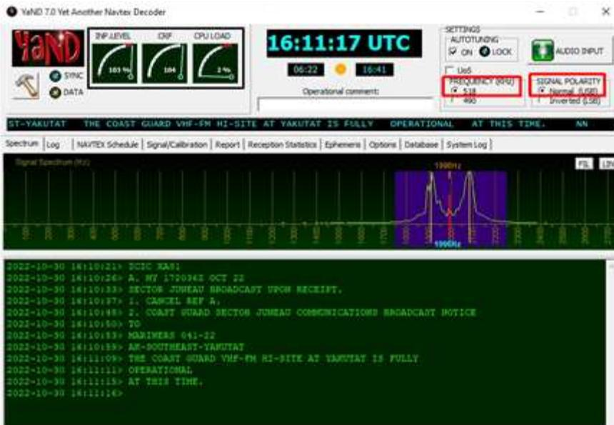
Técnicamente la modulación es del tipo BFSK (Frequency-shift keying binary) a una velocidad de 100 baudios y desplazamiento 170 Hz.
