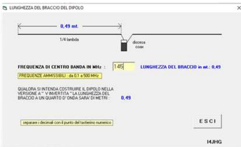
Introduzca la frecuencia en MHz para obtener la longitud precisa para extender el elemento telescópico único.
