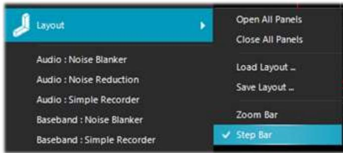
*Si necesita utilizar un paso inesperado, simplemente edite el archivo SDRsharp.config en la clave que comienza con <add key="stepSizes" value=..." e introduzca el nuevo valor, por ejemplo, "3,125 kHz".*
