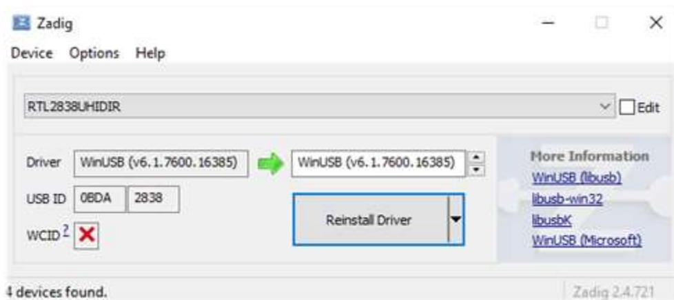
En el menú OPCIONES, seleccione "LISTAR TODOS LOS DISPOSITIVOS" (si es posible, sin ningún otro dispositivo USB conectado al ordenador), y el ID de su dongle debería aparecer en la ventana desplegable, por ejemplo, REALTEK, TERRATEC o en mi caso RTL2838UHIDR. Haga clic en el botón INSTALAR DRIVER o REINSTALAR DRIVER (si ya lo ha hecho). También puedes probar a conectar tu dongle USB después de que Zadig esté funcionando, ya que la lista se actualiza automáticamente por el sistema..
