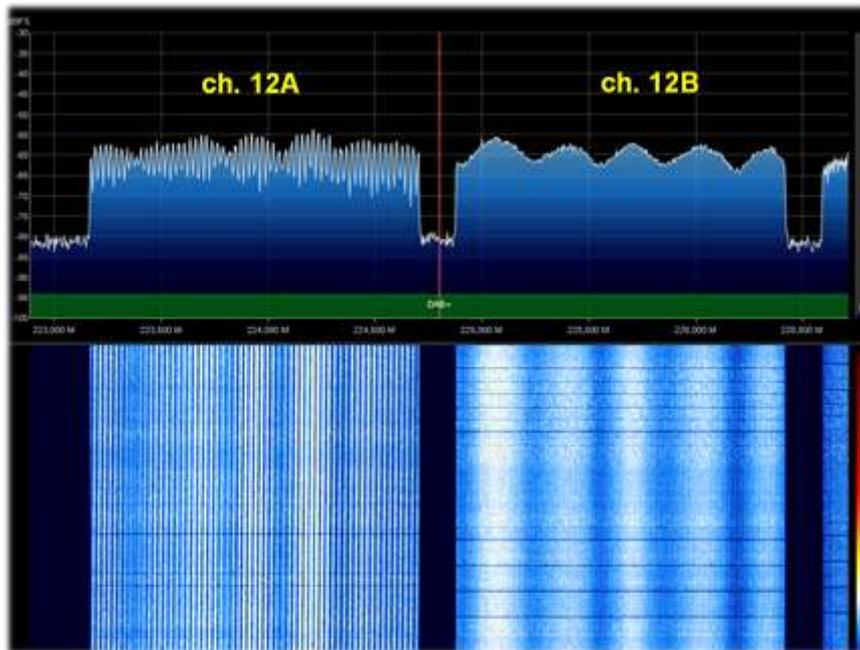
Mi amigo Claudio, un técnico experto en la materia, me explicó que no se pueden ver las diferencias de multitrayecto en el espectro porque hay una señal de codificación que hace que todas sean visualmente iguales. Sin embargo, la diferencia en la conformación de la amplitud de la señal depende de la multitrayectoria o de la composición de dos o más señales a la misma frecuencia que se suman periódicamente con un periodo más o menos largo según la trayectoria o la diferencia de fase.
