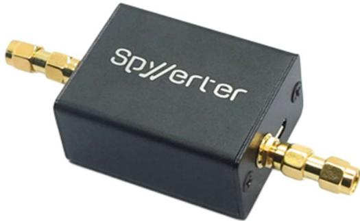
E' un up-converter a bassa perdita, alta gamma dinamica, basato su un design a commutazione, lo stesso tipo che viene utilizzato in rx HF di fascia alta che, grazie alla sua stabilità di frequenza e sensibilità, può competere con i progetti analogici ad un costo assai conveniente.
