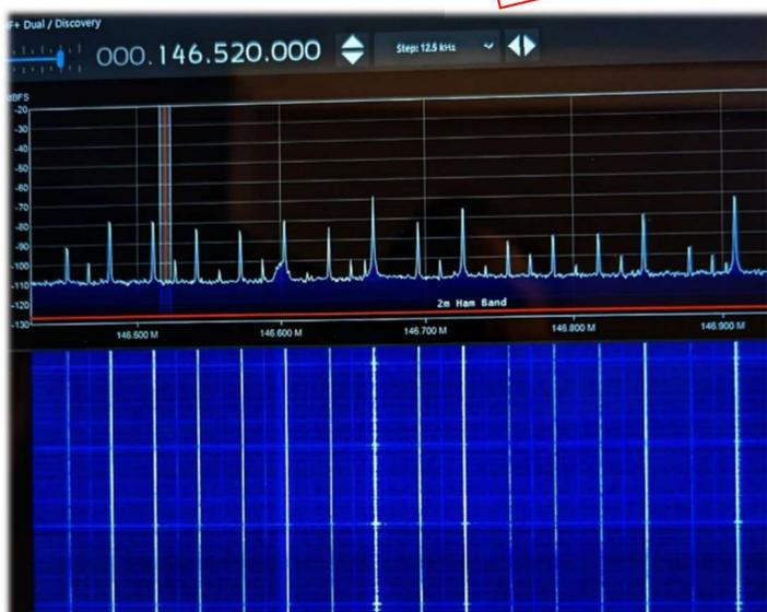
Un HF+ Discovery e una antenna YouLoop hanno permesso di individuare la fonte di questi noises ricorsivi in VHF...
